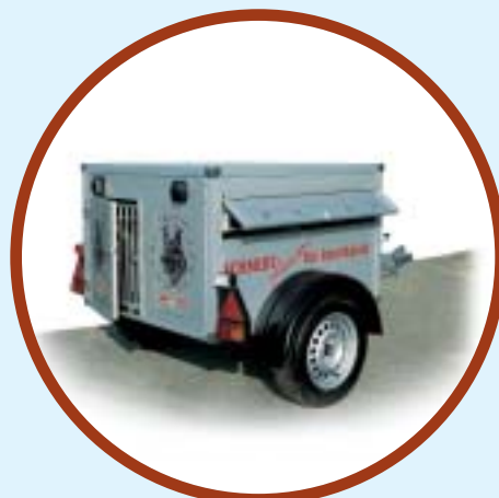
Einachs-Hundeanhänger Typ Junior ohne Dachreling und Staudach (geöffnete Lüfterklappe)
